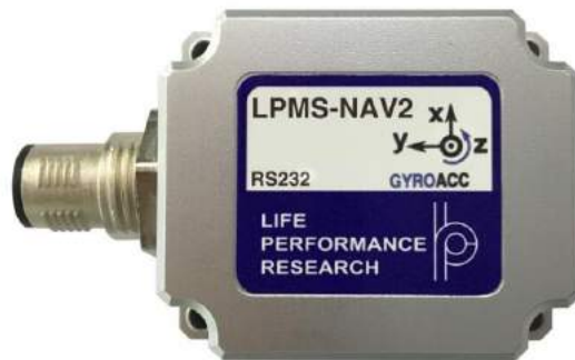
图 3-4 LPMS-NAV2-RS232 参考坐标系
